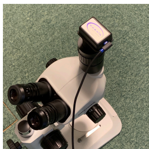
Cマウント対応顕微鏡への取付例
